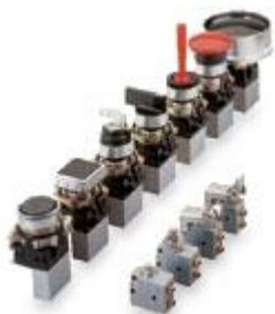
Le micro valvole serie 310 rappresentano la migliore soluzione quando si ha necessità di riduzione degli spazi. Il funzionamento ad otturatore garantisce minimi tempi di risposta del segnale pneumatico, sensibilità di azionamento, affidabilità e lunga durata. Disponibili con connessione ad attacco rapido tubo  $\varnothing$  4mm, a 3 e 5 vie, presentano un corpo in alluminio anodizzato ed un otturatore in OT 58. Fissaggio a pannello ed in linea a mezzo ghiera di bloccaggio.
