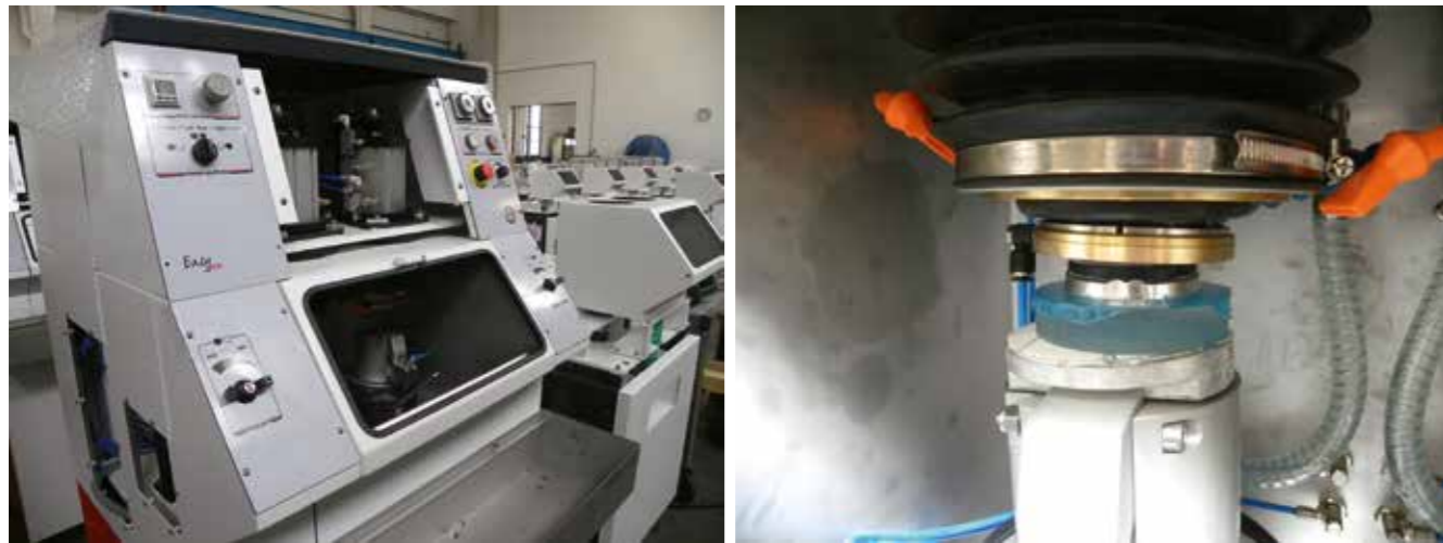
Sistema di levigatura e lucidatura Easy RX e relativa zona di lavoro di Comes.
