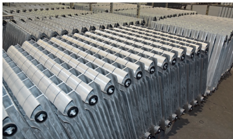
Global effettua test di collaudo sul 100% delle batterie di radiatori prodotti.
